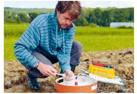
Gasprobenahme in umgebrochener Kunstwiese bei einem Vergleichsversuch in Therwil. Bild: Mercator-Stiftung
